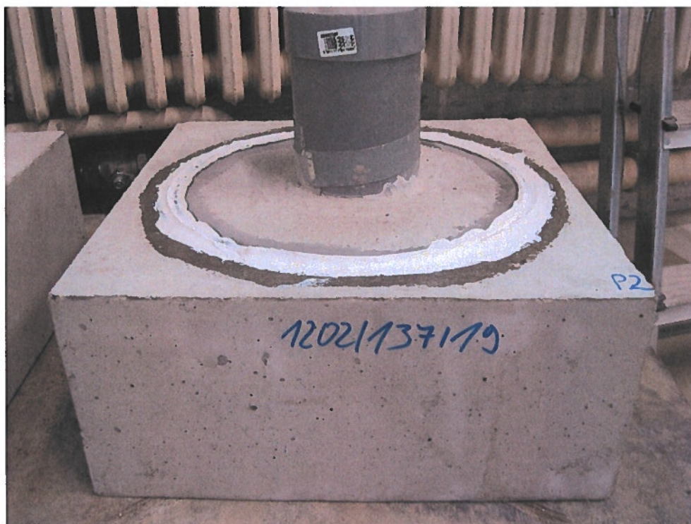
Bild A3: Probekörper nach der Betonage
